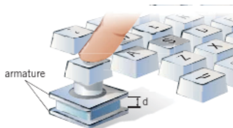
Figura 16 La variazione della distanza d tra le armature cambia la capacità del condensatore posto al di sotto di un tasto del computer.
